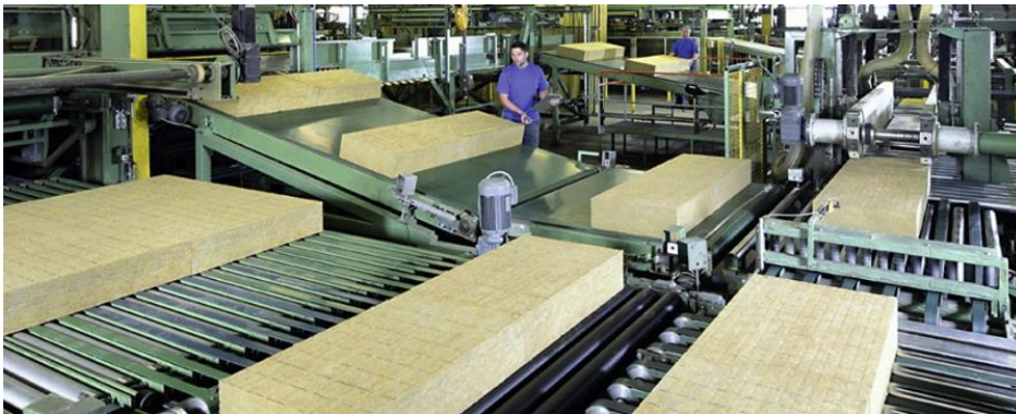
Abb. 7. Produktion von Steinwolle
