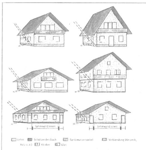
Abbildung 11: Sicherung des Schlagregen- und Spritzwasserbereichs
