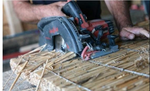
Abb. 13: Handkreissäge
