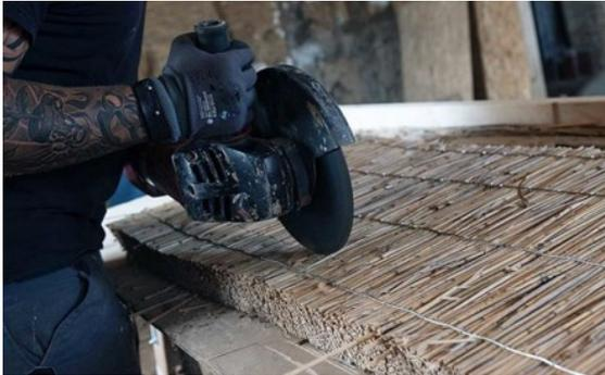
Abb. 12: Winkelschleifer mit Metallblatt
