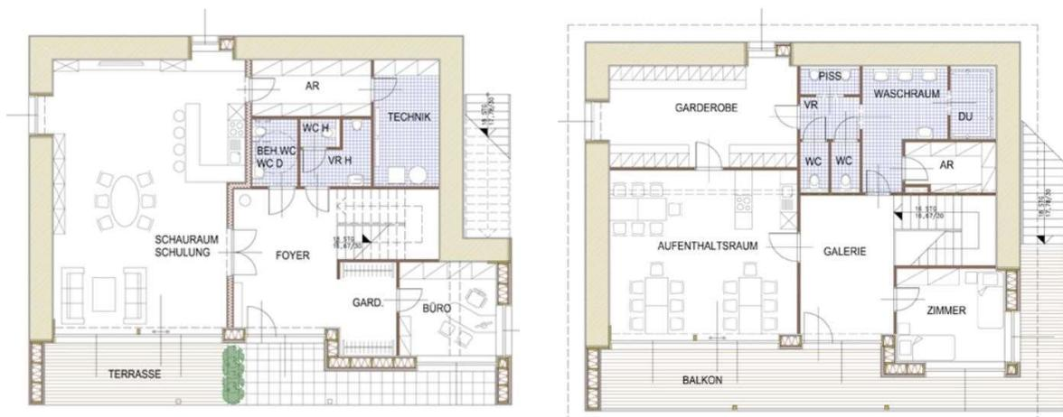
Abbildung 10: Grundriss Erdgeschoss und Obergeschoss Strohballenhaus Ebergassing
