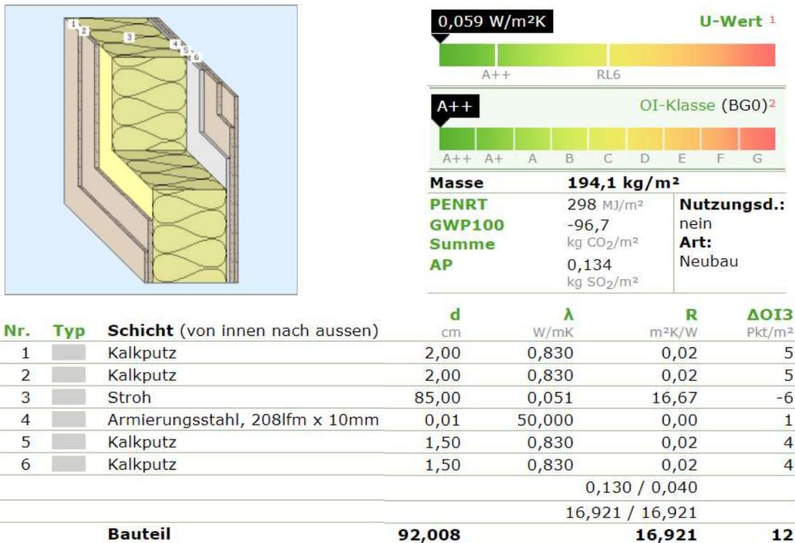
Abbildung 12: Lasttragende Strohballenwand Ebergassing
