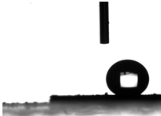
Verhältnis Tropfengröße zu Bohrmehlschichtstärke
