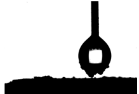
Migration von Bohrmehl in die Flüssigkeits- oberfläche beim Absetzen des Tropfens
