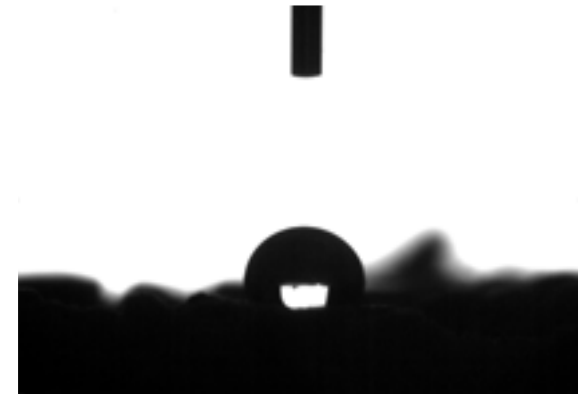
Auswertbarkeit auch bei nicht horizontalen Probenoberflächen gegeben
