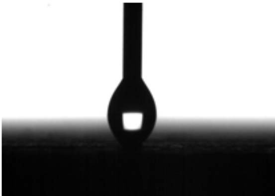
Kräftegleichgewicht zwischen Nadel und Feststoffoberfläche bei zu kleinem Tropfen
