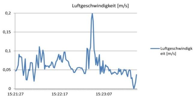
Messung Luftgeschwindigkeit [m/s], Sensor Swema 03+, Swema ISO 7730 Mess-System
